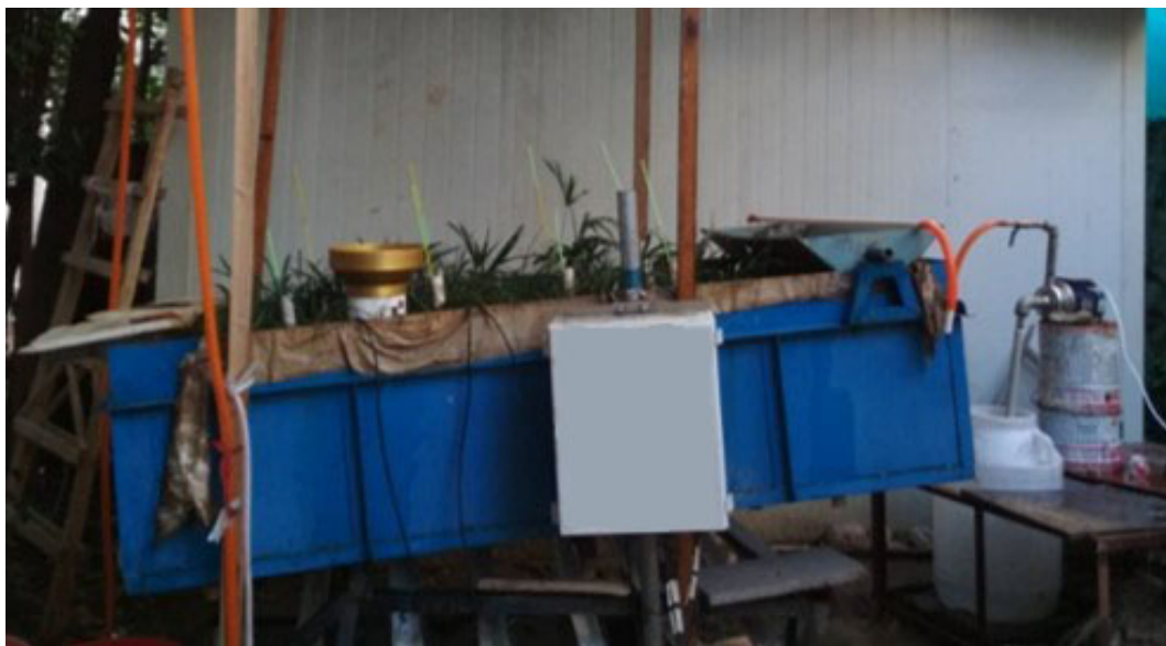
圖 5. 於中國地質大學建置 200 cm 長×100 cm 寬×50 cm 高且可調整坡度的植生濾帶模擬裝置，於此模擬裝置中種植不同密度的植株，探討不同進流量及氮磷濃度、降雨強度、地下水深度、植生密度及坡度對植生濾帶於抑制非點源氮磷污染傳輸的效益。
