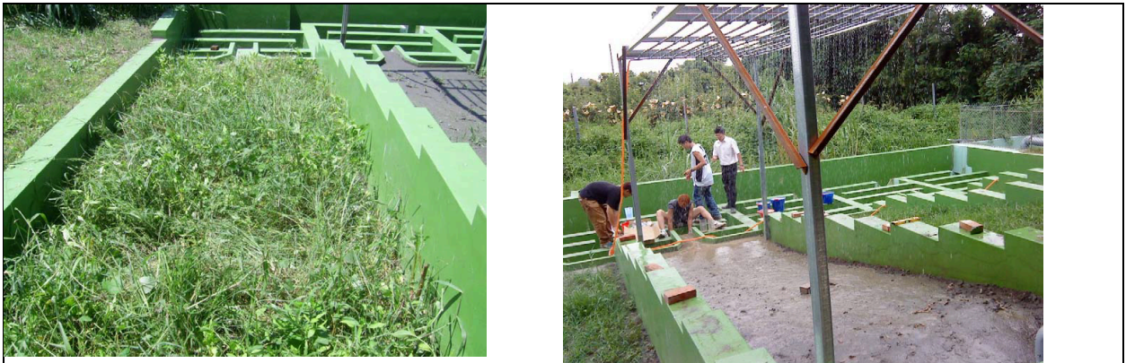
圖 4. 於明道大學任教期間在校內沖蝕場地進行較高邊坡的植生濾帶對沉積物傳輸的抑制效率評估。
