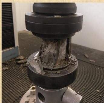
圖一. 試驗機上抗壓測試
