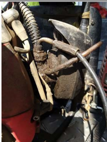
圖 4.機具燃油滲漏將對環境造成汙染
