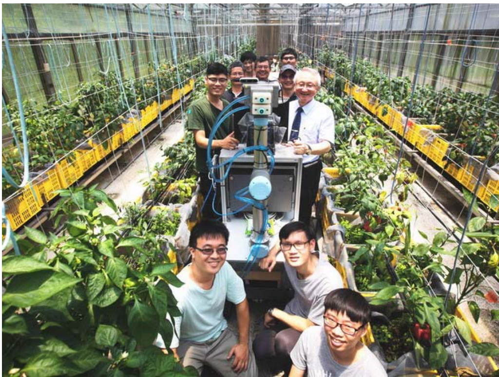
嘉義大學研發的甜椒栽培植保機器人原型，已展現病蟲害管理自動化能力
