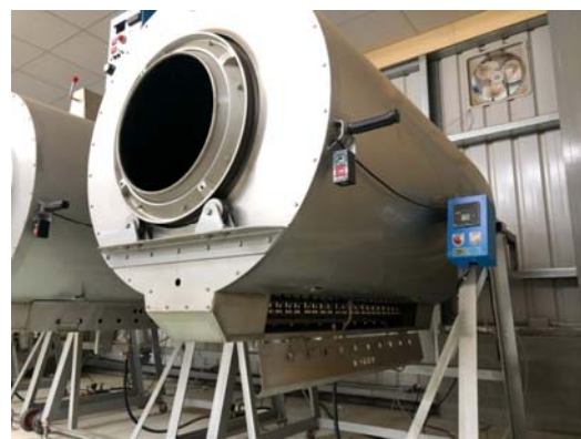
圖 14.炒菁機的內部構造密封，有益於避免茶菁受礦物油渣與多環芳香烴之汙染
