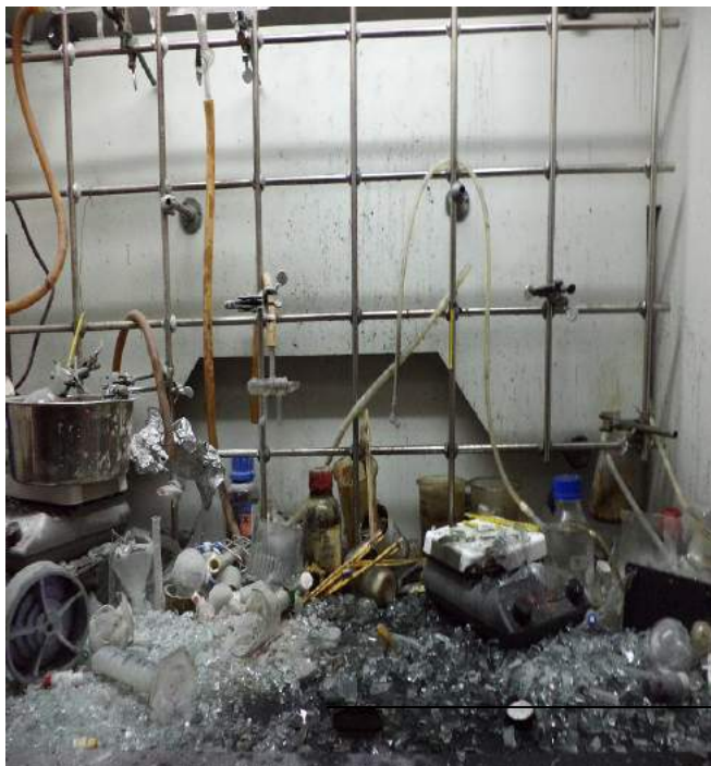
排氣櫃下方因爆炸炸穿導致下方藥品瓶破損
