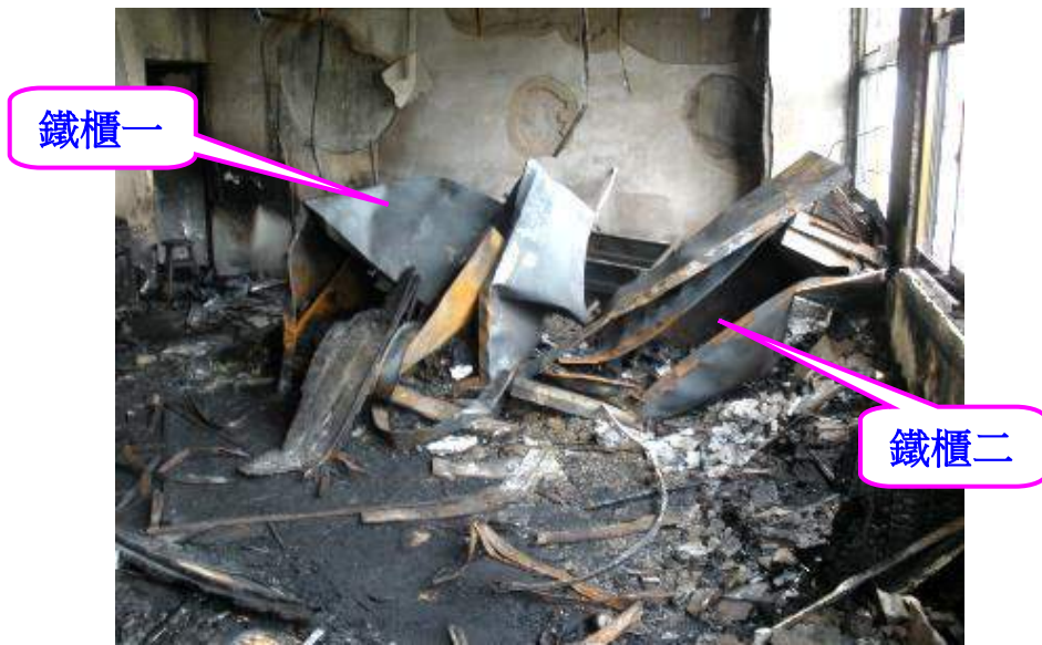
圖三 二個鐵櫃倒塌情形
