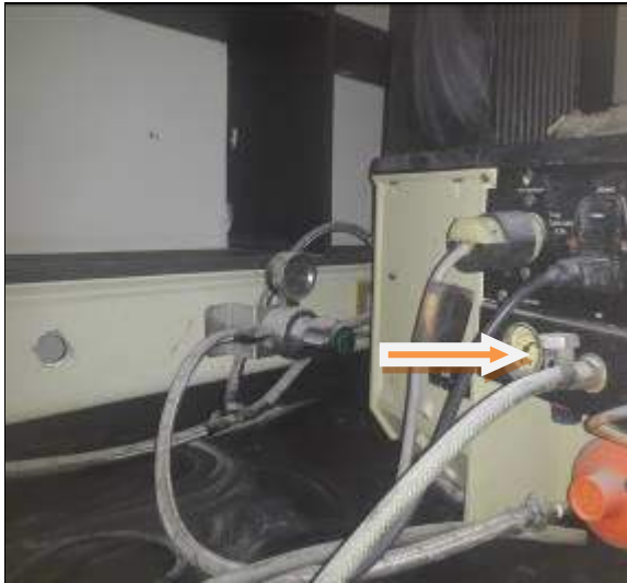
圖 5. 正常之火焰光度計背面(現場同型爆出點原是壓力表)
