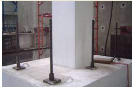
預力鋼棒突出段應加護套
