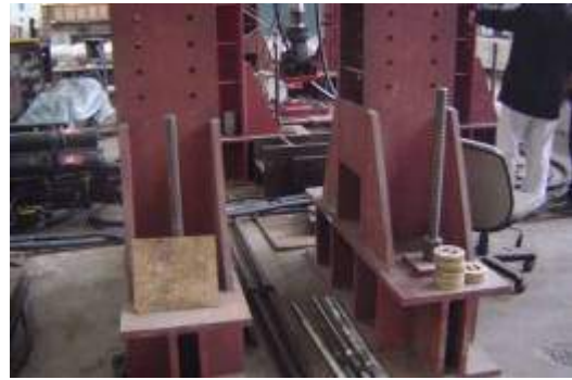
預力鋼棒突出段應加護套
