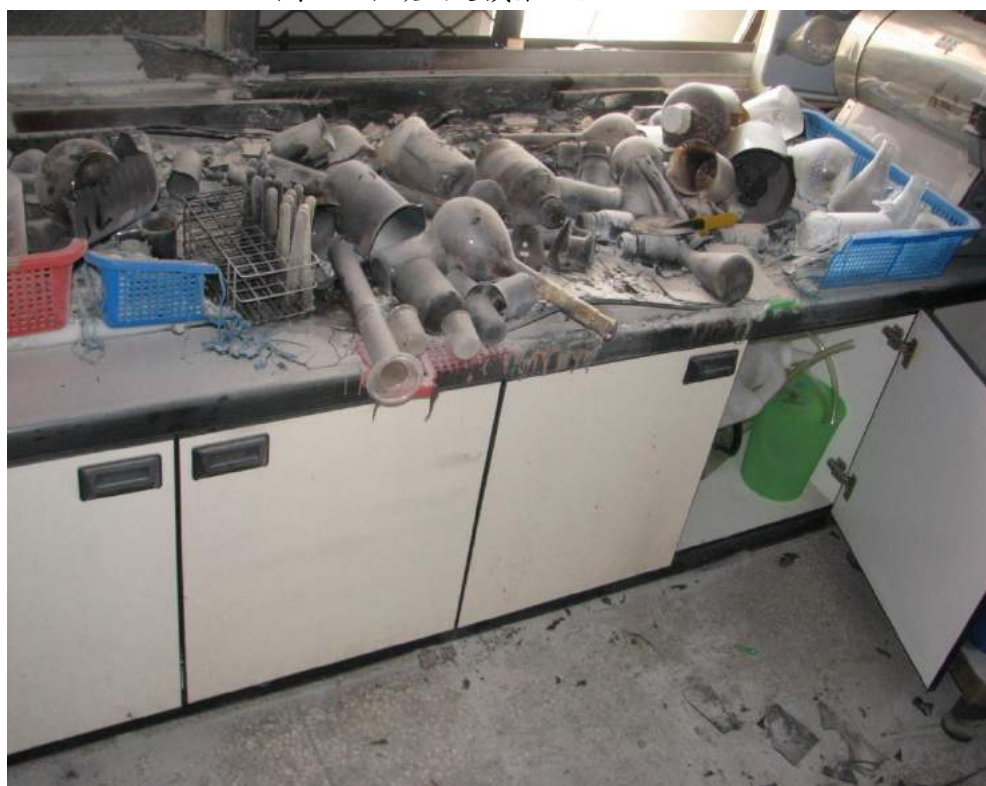
圖二 損毀之實驗桌、燒杯與試管之玻璃容器
