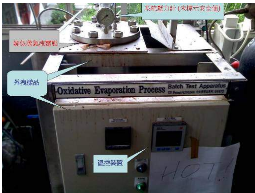
引發本事故之氧化蒸發設備模組(如箭頭)- 注意:實驗室窗戶及遭易碎設備濺波及
