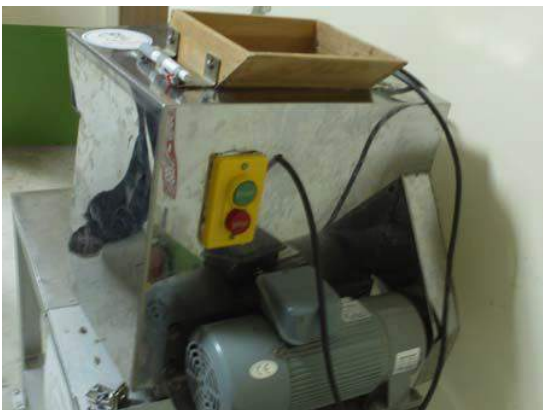
說明：壓麵條機傳動鏈條加裝護蓋
