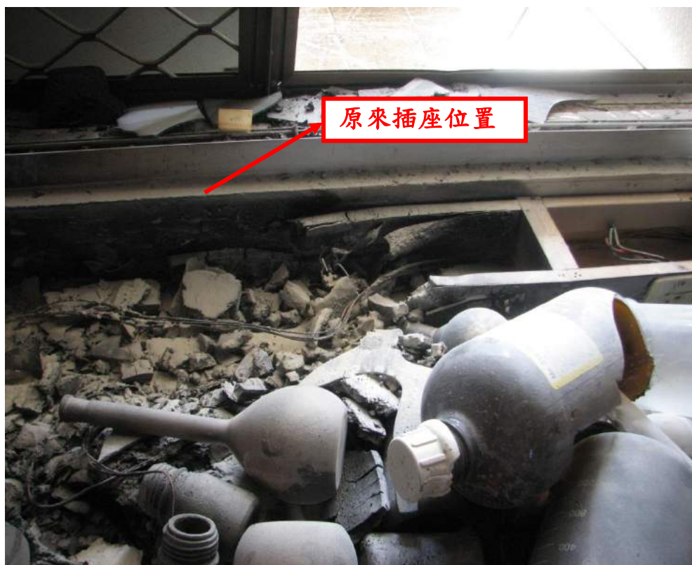
圖一 插座毀損狀況
