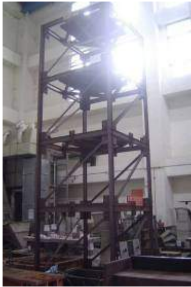
大型實驗構架無適當之爬梯
