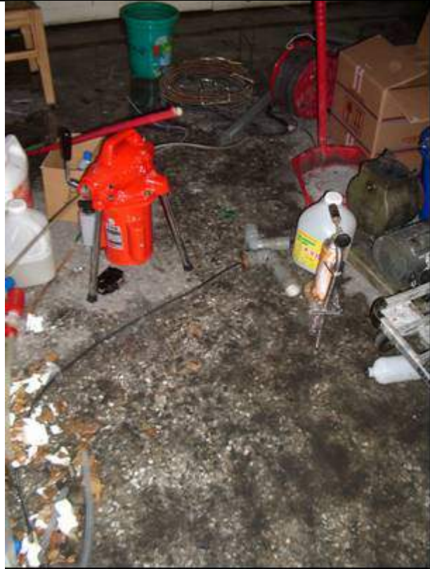
圖 7、承攬商於積水之地面以延長線進行作業
