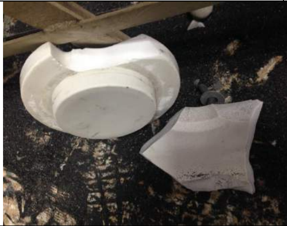
7-球磨鉢蓋及鉢體上方破裂碎片
