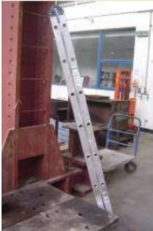
實驗室內使用不具安全性之摺疊梯
