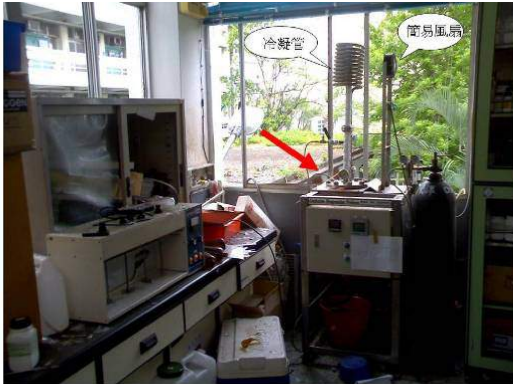
引發本事故之氧化蒸發設備模組(如箭頭)- 注意:實驗室窗戶及遭易碎設備濺波及
