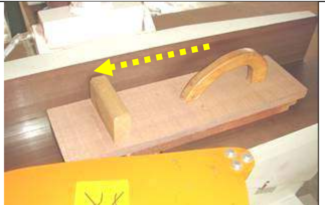
改良後手推板(雙手在推板上，抵板高 1cm)
