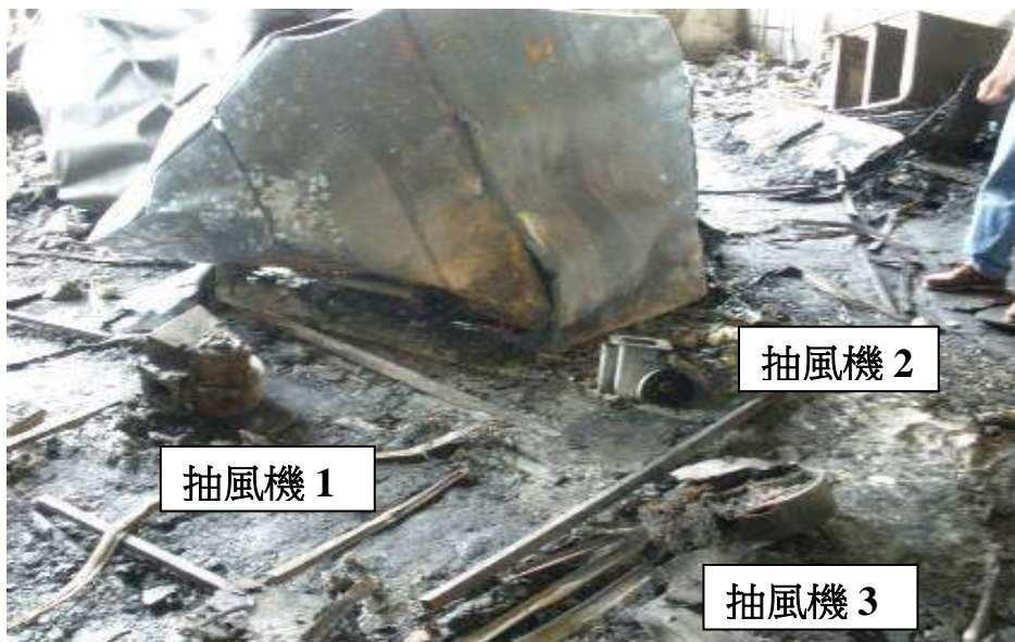
圖四 三個 PP 櫃抽風機散落情形
