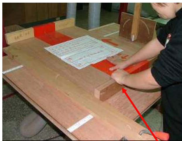
發生事故之圓盤鋸，仿當時學生作業之情形，以右手壓住木材往前推，但未確實使用進料推盤。
