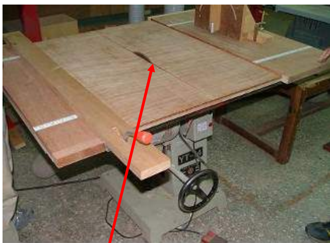
發生事故之圓盤鋸，未設鋸齒接觸預防裝置及反撥預防裝置
