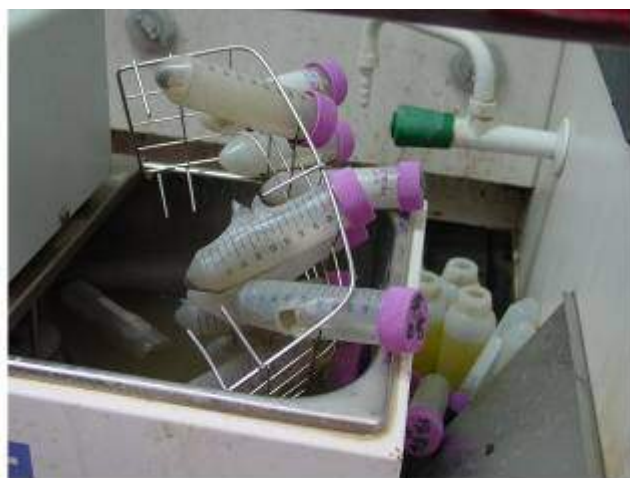
炸裂之實驗用塑膠管
