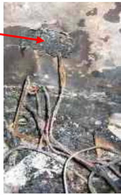
圖一 牆壁上插座與插頭熔融情形
