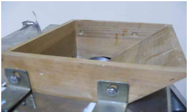
說明：木箱具有阻隔功能(但深度不足)
