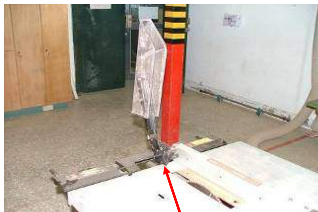
木材加工用圓盤鋸設有鋸齒接觸預防裝置及反撥預防裝置
