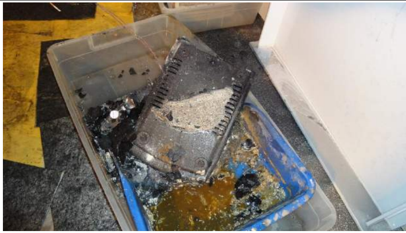
移出毀損陶瓷加熱攪拌器
