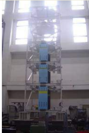
大型實驗構架無適當之爬梯
