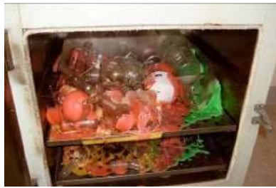
圖六 烘箱常因溫控系統老舊失靈，致使烘箱溫度過高而引發意外。
