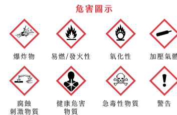
圖八 (左) 全球調和制度 (GHS) 危害分類圖示；(右) 常見問題發生在老舊化學品上。舊化學品未依規定貼上危害圖示與加註說明。
