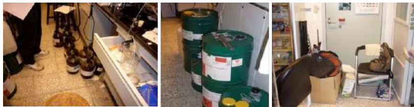
圖九 化學品任意擺放在地上，與阻塞走廊通道，是實驗室常見之弊病。
