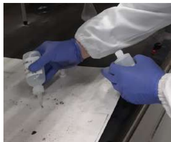
圖一 使用吸瓶吸除汞液滴。
