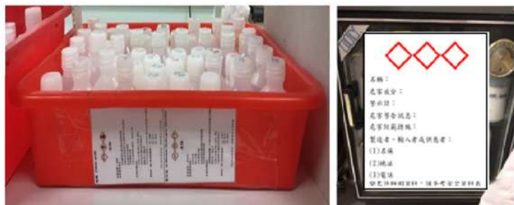
圖三十一 規劃各類化學品存放區域，並在盛盤外部張貼危害標示
