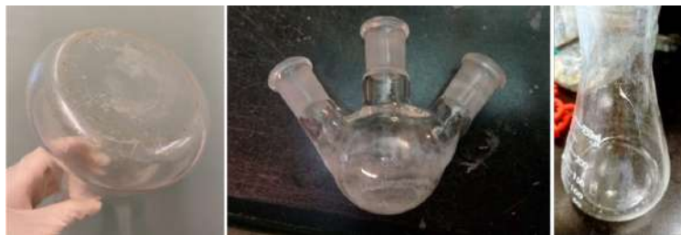
圖二十二 左邊的三角燒瓶未清洗乾淨；中間的多頸圓底瓶經化學品腐蝕；右邊的有一道裂痕
