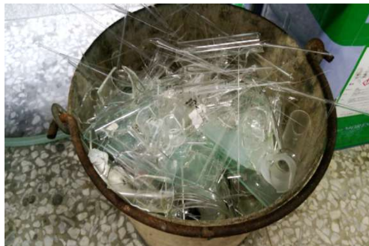
圖二十六 廢棄碎玻璃應先清理乾淨，收集在堅固而不易刺穿的載具中暫存，上圖的玻璃收集太滿，廢玻璃已突出桶外會有刺劃傷風險。
