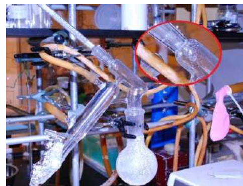
圖二十八 蒸餾時爆裂的水銀溫度計，水銀球因爆裂而掉落圓底瓶中
