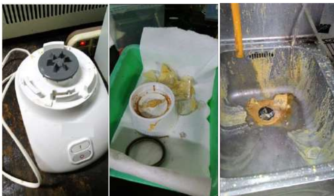
圖二十七 左邊為使用的攪拌器；中間為爆裂的研磨杯；右邊為現場水槽
