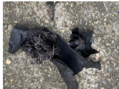
照片 1 電纜中間接頭處遭電流擊穿破損
