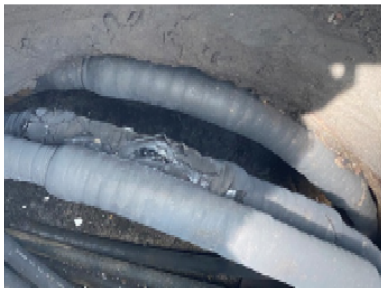
照片 1 電纜中間接頭處遭電流擊穿破損
